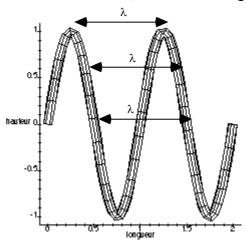
La longueur d'onde  $\lambda$  (lambda grec) de l'onde est la distance entre deux maxima ou minima. C'est, plus généralement, la distance séparant deux points de la corde se déplaçant dans le même sens avec la même amplitude (se déplaçant en phase).  $\lambda$  caractérise la périodicité spatiale de l'onde.
