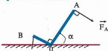
Un pied de biche dont on négligera la masse est constitué par une tige AOB coudée à angle droit. L'opérateur doit exercer une force d'intensité  $F_A = 250 \text{ N}$  pour arracher le clou enfoncé dans la poutre. Calculez l'intensité  $F_B$  de la force de résistance à l'arrachement du clou.
