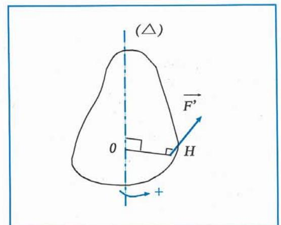
Fig. 2. Le moment de la force  $\vec{F}$  est positif, compte tenu de l'orientation choisie.
