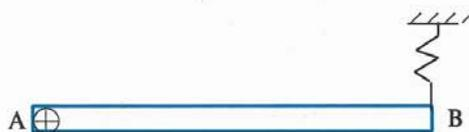
Une tige AB homogène, de masse  $m = 2,5 \text{ kg}$  et de longueur  $l = 80 \text{ cm}$  est mobile autour d'un axe fixe  $\Delta$  passant par A. Elle est maintenue en équilibre horizontalement par un ressort de raideur  $k = 160 \text{ N.m}^{-1}$  accroché en B.
