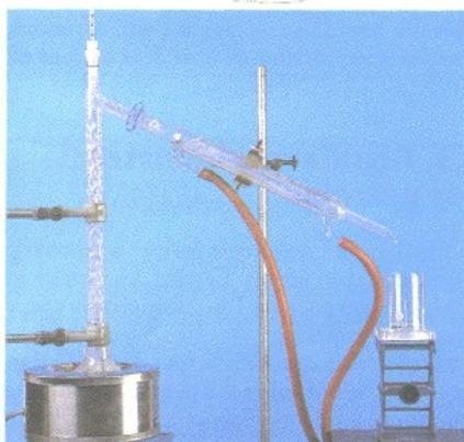
Fig. 13. Distillation fractionnée. La colonne Vigreux sépare les deux constituants du mélange, le réfrigérant condense les vapeurs que l'on recueille dans un bécher.
